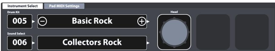
Wenn die gewünschte Komponente ausgewählt ist, tippen Sie auf das Namensfeld **[Sound Select]**, um den **Sound Browser** zu öffnen. Durch Doppeltippen eines Listeneintrags weisen sie der aktiven Komponente einen neuen Sound zu. Nach dieser Operation schließt der Sound Browser automatisch.
