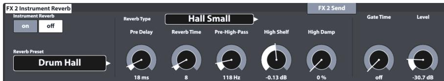
Dieses Modul enthält klassische und generische Algorithmen, um instrumentspezifischen Hall zu simulieren. Einige **Reverb Typen** werden traditionell elektronisch erzeugt, während andere (z.B. Plate) mechanische Geräte emulieren, die dem Dry Signal künstlichen Hall hinzufügen.
