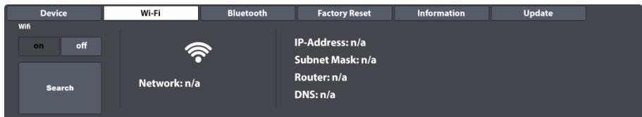
Innerhalb dieses Reiters werden WLAN-Verbindungen und -Einstellungen verwaltet. Die Wi-Fi Verbindung ist wichtig für die Nutzung des Sound-Stores online sowie für die Durchführung von Geräteaktualisierungen aus dem Modul heraus.
