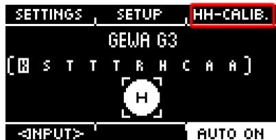
Im nächsten Dialog werden Sie aufgefordert, die Hi-Hat mit Hilfe des Pedals maximal zu schließen. Folgen Sie der Anweisung und drücken Sie [F1] "NEXT".
