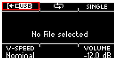
Wählen Sie mit den Navigationstasten [8] oder dem Drehregler [5] den **Ordner oder Song** aus der Liste aus. Zum Laden, drücken Sie [F1] oder [ENTER] oder brechen Sie den Vorgang mit [F3] ab.
