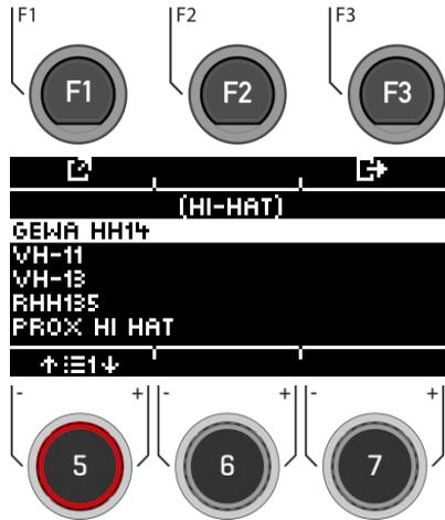
Wählen Sie den Trigger mit dem Drehregler [5] oder den Navigationstasten [8]. Bestätigen Sie Ihre Auswahl mit [F1] oder durch Drücken von [ENTER].
