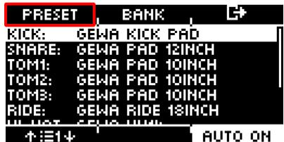
Wählen Sie mit dem Drehregler [5] oder den Navigationstasten [8] aus der Liste Ihr GEWA Set und bestätigen Sie über [F1]. Der Vorgang ist nun abgeschlossen und Ihr GEWA Drumset optimal auf das G3/G5 Modul abgestimmt.
