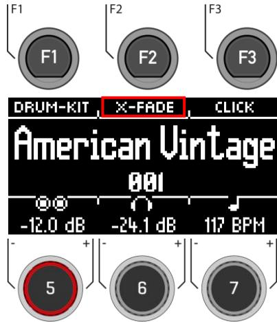
4. X-Fade EDIT = Es öffnet sich ein Fenster mit einem Fader. Nun können Sie mit dem Drehregler [6] den Schwellenwert einstellen, der für Sie passend ist. Das Fenster schließt nach 2 Sekunden automatisch.
